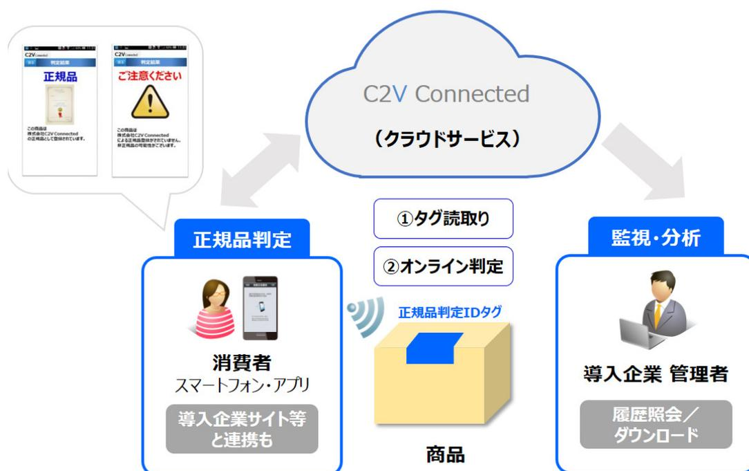
製品に付したタグをスマートフォンで読み取るだけで、判定結果が示される
