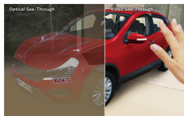
CGが透過しないビデオシースルー方式により、前後関係の表現が可能
