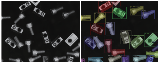
図2. AI活用による製造部品(ボルト、ナット)の領域抽出
