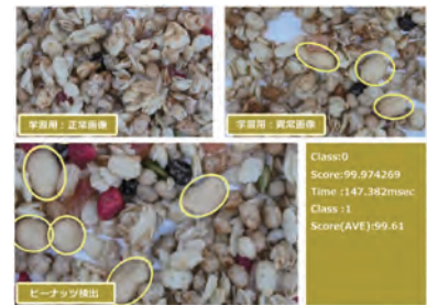
図9. AI技術活用の食品異物混入検査システム事例(協力:Matrox社)
