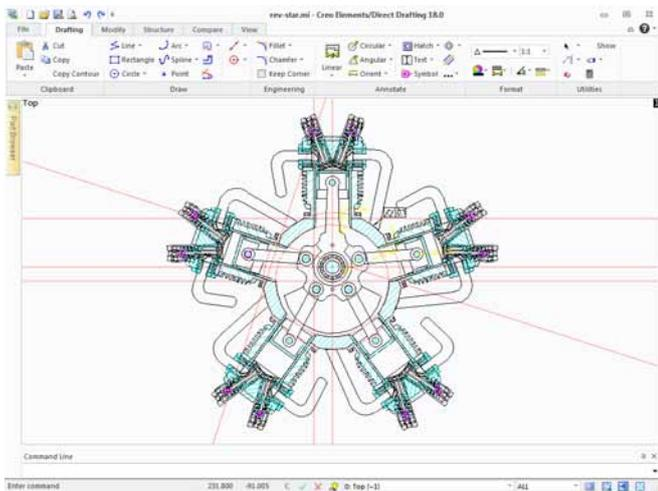
Creo Elements/Direct Drafting は、機械工学のエンジニアや設計者の専門的なニーズに応える包括的な 2D CAD システムです。
