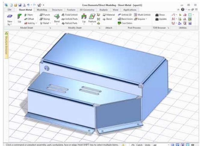
Creo Elements/Direct Sheet Metal の知識データベースは、その製造ツールとともに、設計の製造可能性を確保します。
