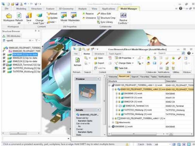
Creo Elements/Direct Model Manager のステータスとリビジョン通知により、Creo Elements/Direct Modelingの構造一覧内で常に最新の情報を表示します。
