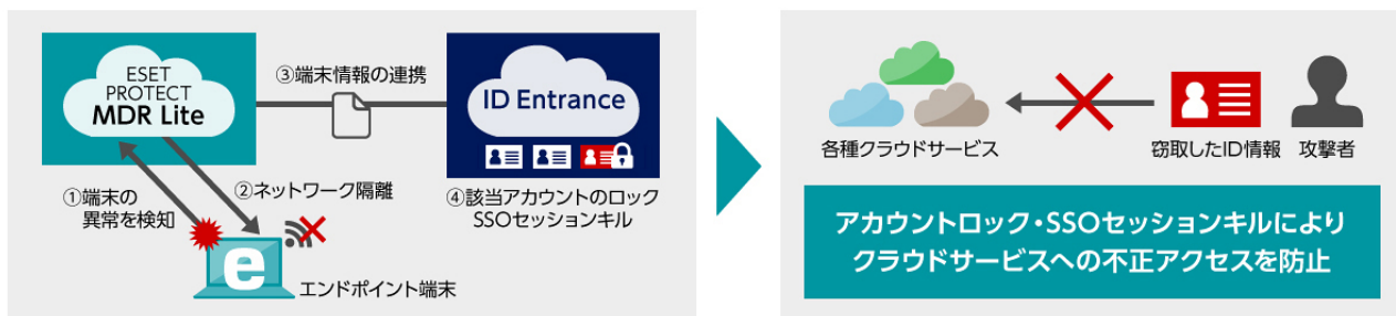
「ID Entrance」の新機能による「ESET PROTECT MDR Lite」との連携概要
