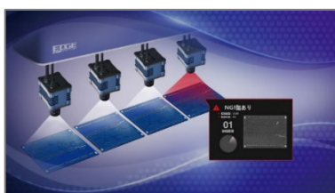
(1) PCB基板キズ検査
