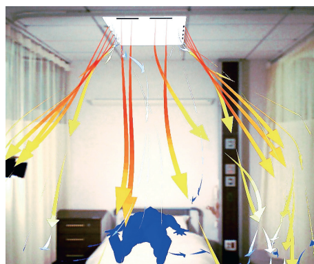
ヘッドマウントディスプレイでは、実際の映像にデータが合成された映像が表示される
